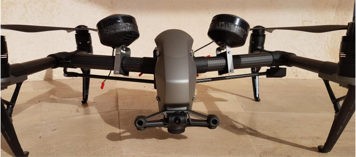
Ne pas oublier de brancher les deux parachutes avant le décollage du drone. Le branchement se fait par les deux prises rouges de chaque côté. Les parachutes peuvent rester brancher.
